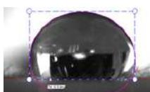
Σταγόνα λαδιού σε πάπιρο τροποποιημένο με SPH
